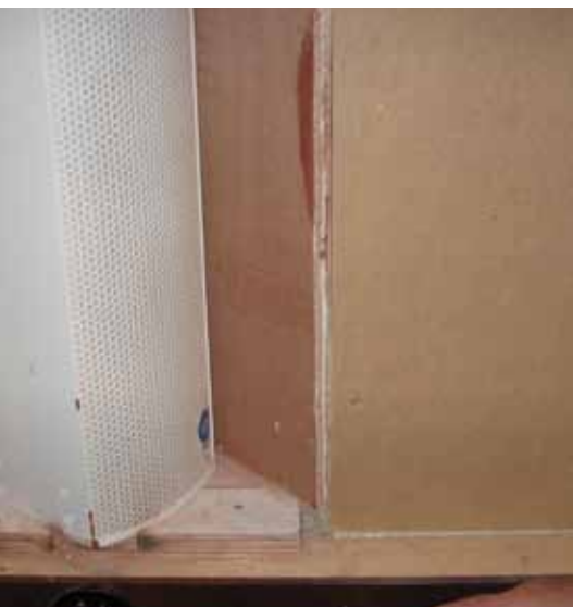
Links koof zonder foam, rechts koof met foam. Midden het meetplaatje met vergelijking van die twee.
