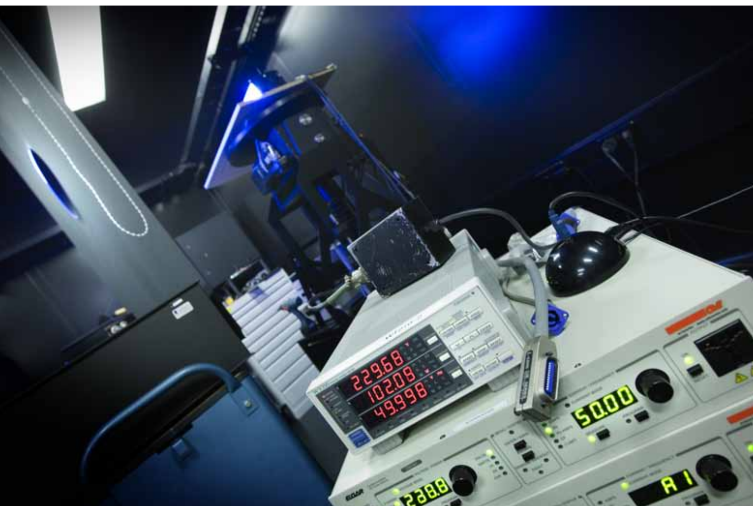
Meetopstelling in het VSL-laboratorium. Iets bov en het midden de rotatietafel waarop elk armatuur gemonteerd werd. | FOTO: © ROB ACKET |
